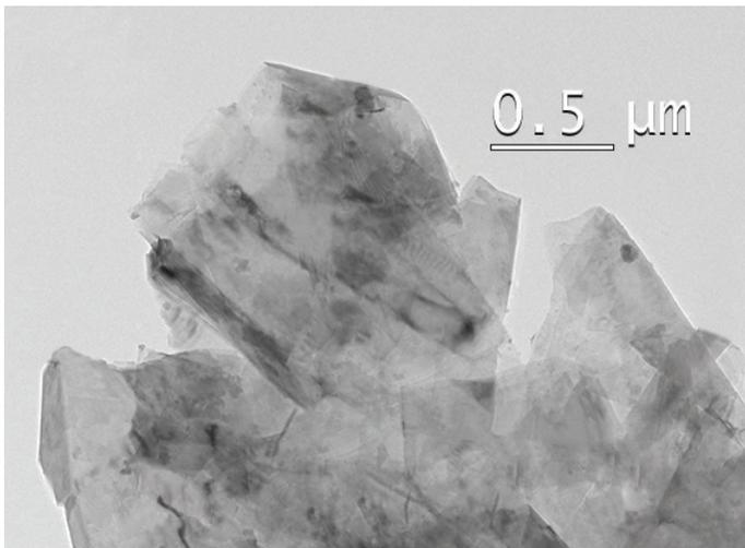
Micrographie électronique en transmission (MET) montrant différents flocons d'épaisseur variant entre 6 et 10 couches.
